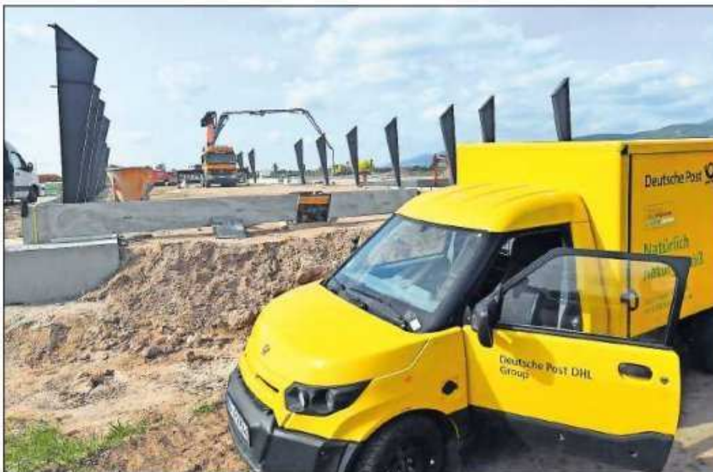
Den Street-Scooter – hier vor dem Fundament des neuen Zustellstützpunktes – baut die Post in Zusammenarbeit mit der Technischen Hochschule Aachen selbst. Er hat eine Reichweite von 80 Kilometern.
